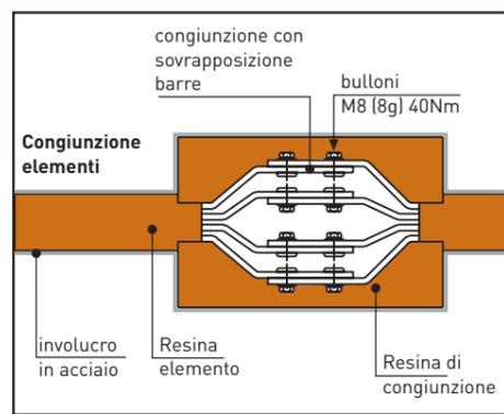
La speciale resinatura adottata consente una semplice e veloce installazione in assoluta sicurezza garantendo il grado di protezione IP68.
